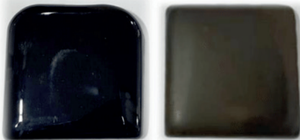
Figura 4. Monolitos de vidro e vitro-cerâmica obtidos a partir do resíduo U3M.
