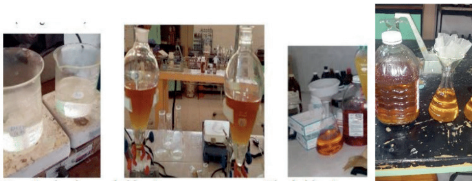
Figura 4 prelavado y secado del aceite Filtrado del aceite comestible usado fuente propia.
