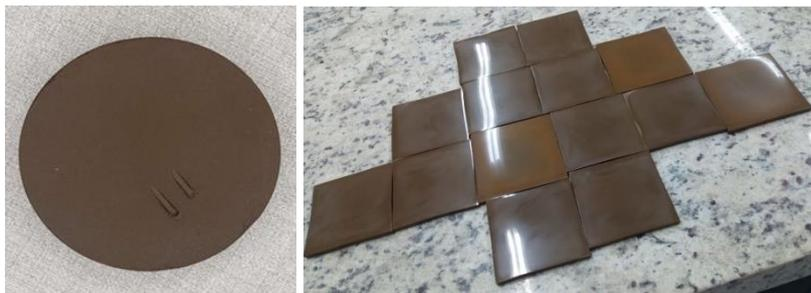
Figura 3. À esquerda, (a) disco de 50 mm de diâmetro usado para avaliação da condição de máxima densificação. À direita, (b) placas de 100 mm x 100 mm de aresta utilizadas para ensaio de resistência à flexão.
